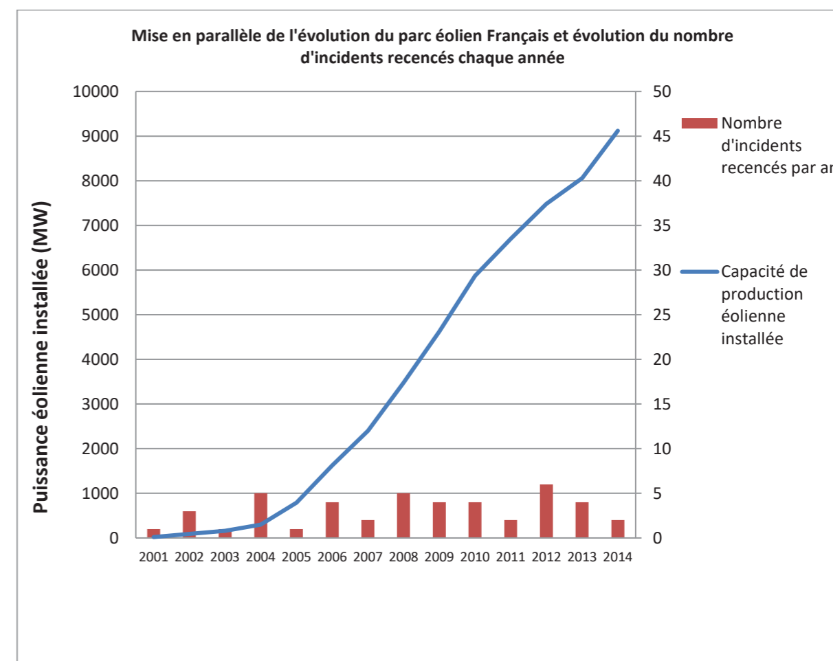
Figure 2 : Evolution du nombre d'incidents annuels en France et nombre d'éoliennes installées On note bien l'essor de la filière française à partir de 2005, alors que le nombre d'accident reste relativement constant
